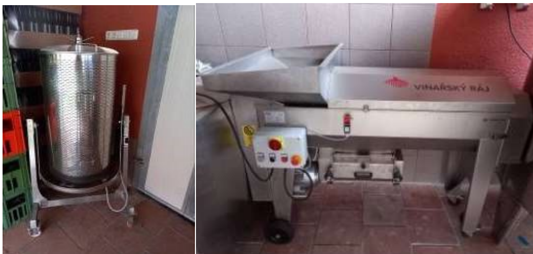
Obr. 5 Příklad projektu z PRV: hydrolis a mlýnkoodzrňovač firmy Klásek
